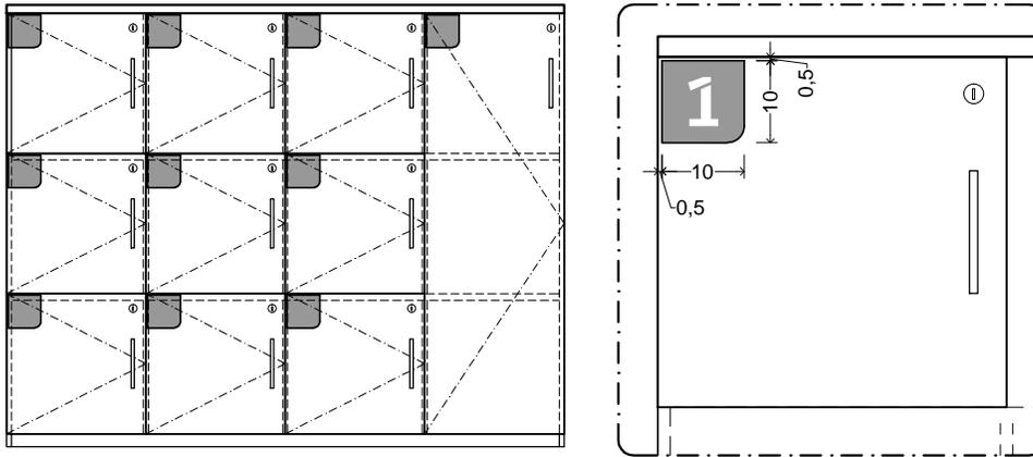
Señal de 10x10cm, fabricada en vinilo adhesivo cortado en plotter de corte, adherido a la superficie de la puerta.
